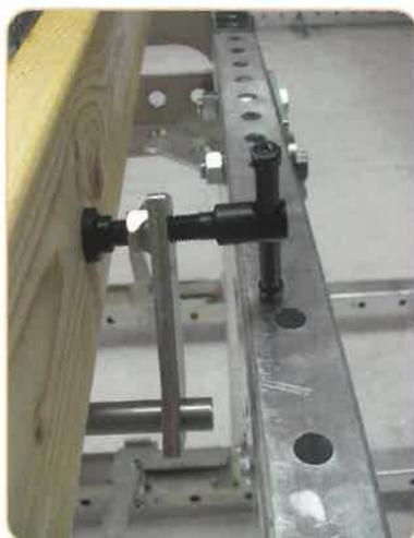
Les éléments de positionnement et de serrage sont tous de conception et d'utilisation simple, ne nécessitant pas l'utilisation de clefs.
