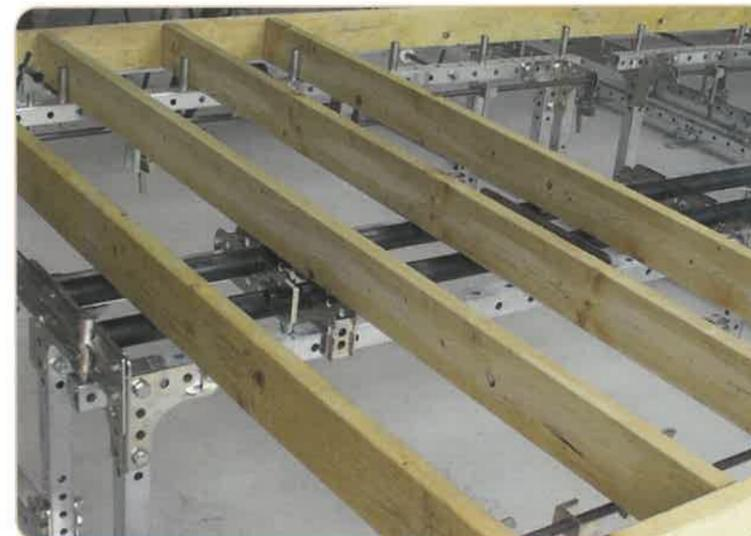
Les chevalets intermédiaires à rouleaux permettent une intégration aisée des éléments préfabriqués tel que encadrements, linteaux, entretoises ...
