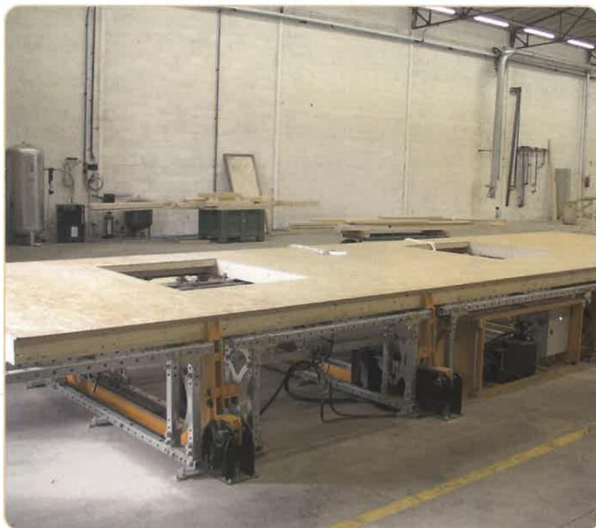
La table cadreuse ossature bois évolutive a d'abord été conçue pour positionner et maintenir les pièces de bois composant un panneau de maison à ossatures bois afin de les fixer par clouage entre eux. Dès sa conception, il a été tout spécialement pris en compte le confort et la sécurité des opérateurs. La table étant ouverte, l'opérateur positionne debout, à hauteur d'homme, les pièces de bois, éliminant ainsi le travail à genoux.
