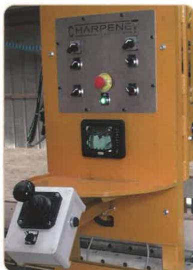
Il dispose, pour positionner la tête de clouage avec précision, de pointeurs lasers qui lui indiquent la position des montants. Embarquée dans la tête de clouage, une caméra permet depuis le poste de pilotage de réaliser le clouage au niveau des ouvertures en toute simplicité.
