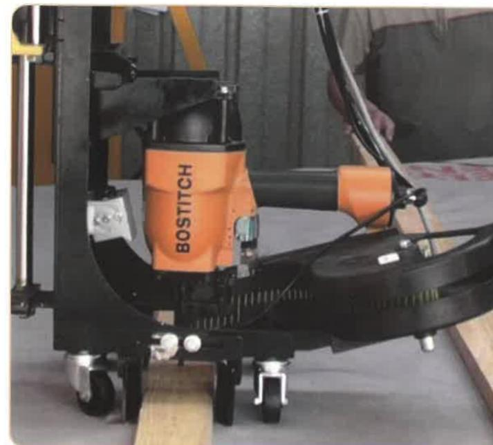
Le clouage des liteaux se réalise également en toute simplicité. Toujours aidé pour se positionner par les pointeurs lasers, l'opérateur place la tête de clouage au dessus d'un montant. Il place alors le liteau dans le guide intégré et déplace la tête de clouage ce qui a pour effet de clouer le liteau, tout en le redressant, à l'entraxe sélectionné.
