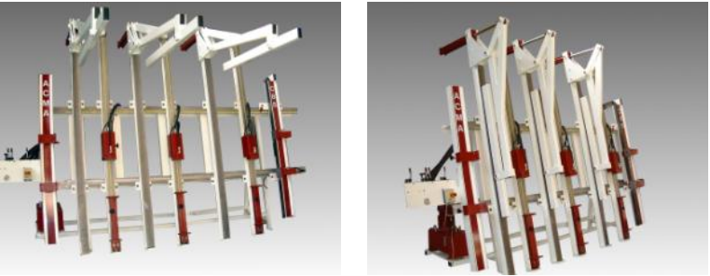
Exemple d'une cadreuse à traverses C 85 équipée avec 3 presseurs supplémentaires pour réaliser du panneautage.
