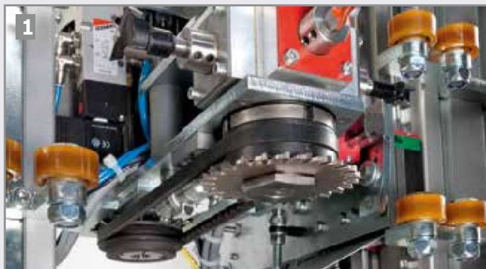
Vue de l'ensemble équipé de sa lame pour la fabrication de rainures
