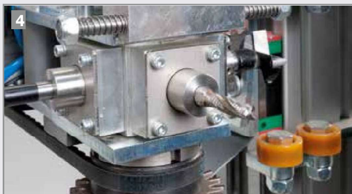
Vue de l'ensemble équipé de sa mèche de 8mm pour la réalisation de perçage (tourillons)
