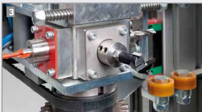
Vue de l'ensemble équipé de sa mèche de 20 mm pour système minifix
