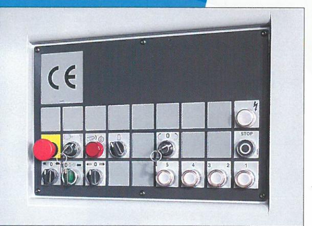
Tutti i principali comandi e dispositivi di regolazione sono ergonomicamente posizionati in prossimità del "posto operatore". Con un semplice gesto è possibile modificare o verificare l'esatta impostazione della macchina per il lavoro che si andrà ad eseguire.
