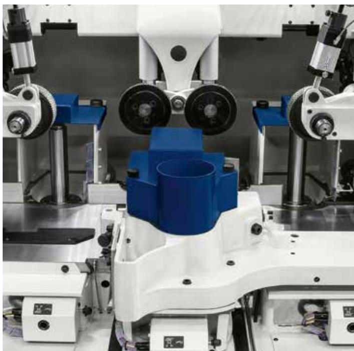
Dans les compositions avec deux arbres horizontaux supérieurs le 2<sup>ème</sup> arbre vertical droit est disponible, avec et sans arbre universel.
