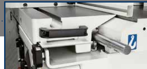
class tf 130ps avec chariot coulissant frontal Conçue pour gérer les opérations de tenonnage en totale simplicité.
