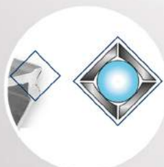
Le profil « archiforme » des guides class en acier spécial rectifié en forme d'arc (solution SCM)
