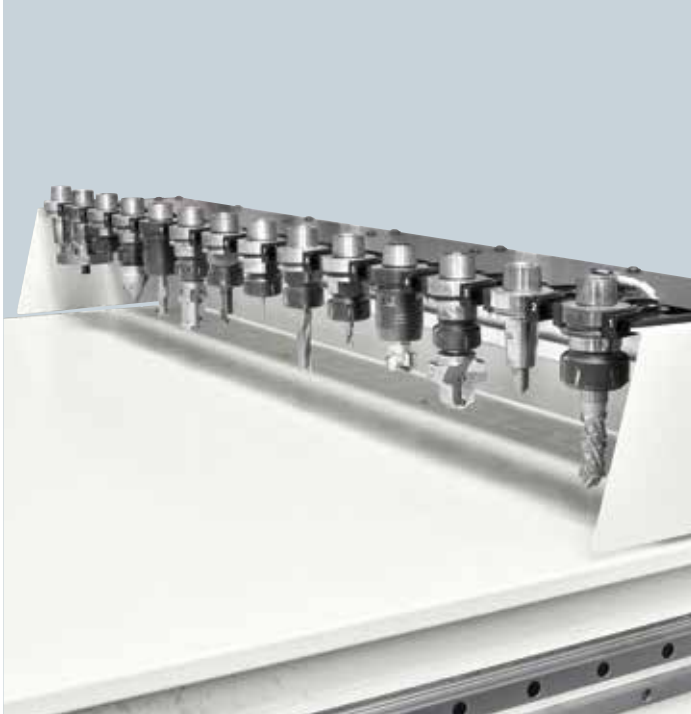
Magasin TRB jusqu'à 19 positions.
