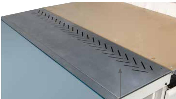
**Environnement de travail propre** avec le dispositif de récupération des copeaux positionné entre le plan de travail et le tapis de déchargement.
