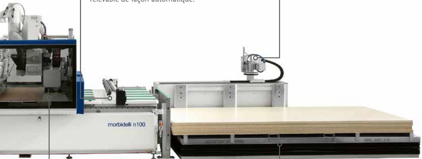
**Positionnement précis et rapide** des panneaux sur le plan de travail avec le groupe de chargement à ventouses.
