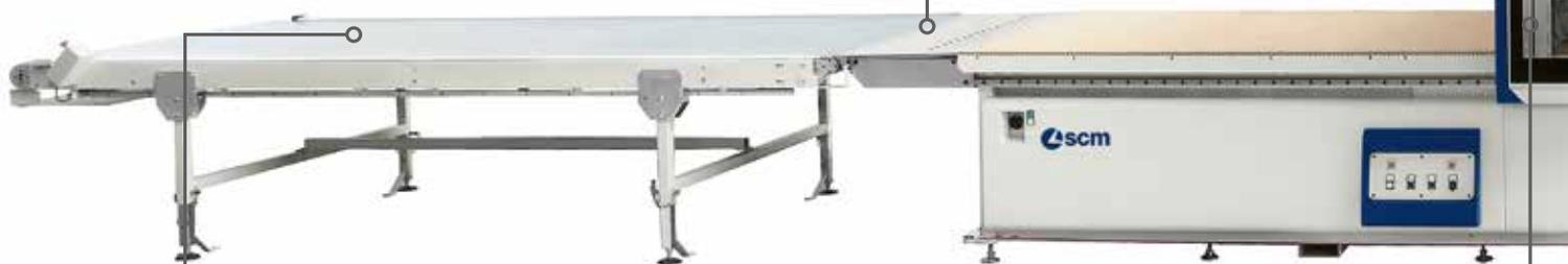
**Tapis de déchargement** avec photocellule d'arrêt.
