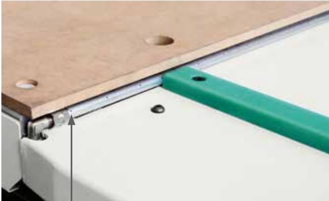
**Système de nettoyage du panneau** garantissant un maintien optimal de la pièce: le nettoyage du panneau à l'entrée et du plan de travail est effectué par des micro-jets d'air pulsé. Magasin outil relevable de façon automatique.
