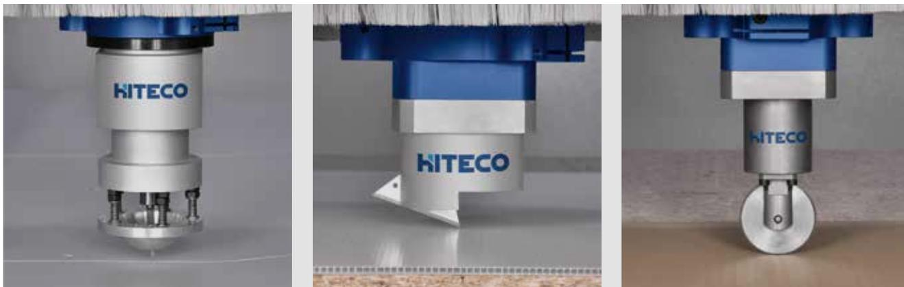
Gamme de têtes dédiées à l'usinage des matériaux spéciaux et extra-bois, comme le plexiglas, le plastique, l'alucobond, l'aluminium, les mousses de polyuréthane et le carton alvéolaire.
