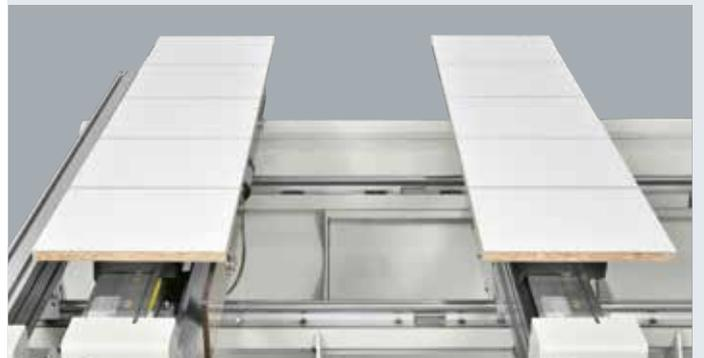
*D'un seul panneau on peut obtenir plusieurs éléments et les repositionner automatiquement pour réaliser tous les usinages nécessaires sans jamais interrompre le cycle productif ; à la fin, les pièces sont retournées à leur position initiale pour faciliter le déchargement du plan de travail.*
