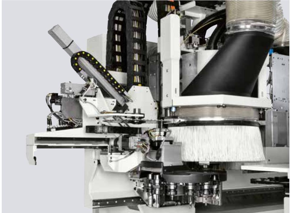
Le magasin outils « VELOCE » à bord à 12 ou 16 positions, positionné à côté de l'électrobroche, permet de changer les outils en temps masqué. Il est disponible même avec le "pick-up" pour lame supplémentaire.
