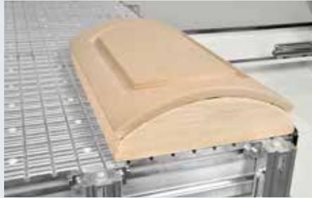
*Positionnement simple et rapide des accessoires de blocage tels que les ventouses MPS et le système MODULSET avec structure à canalisations en surface.*
