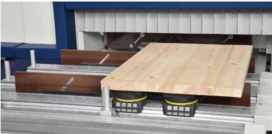
*Positionnement facile des pièces lourdes et panneaux de grandes dimensions grâce au dispositif de soulèvement.*
