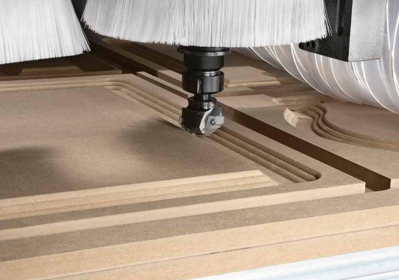
*Précision d'usinage optimale avec l'électromandrin à 3 axes jusqu'à 24.000 t/min.*
