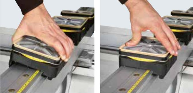
*Il est possible d'ajouter ou d'enlever des ventouses ou des étaux d'un simple mouvement de la main ; le nombre et la position sont relevés en automatique.*
