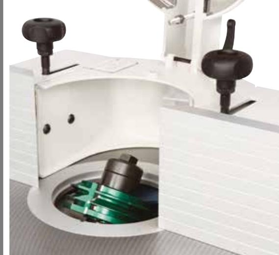
Sur demande, il est possible de commander l'option: arbre de toupie inclinable à 45° vers l'intérieur de la machine (seulement pour st 3c et tw 45c).
