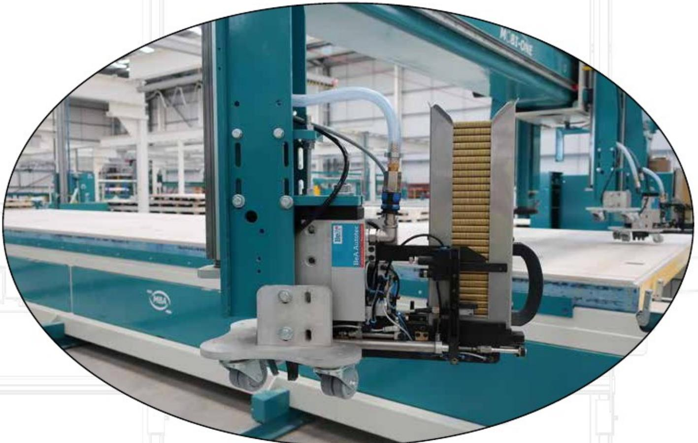
Station de cadrage et de clouage automatique de haute qualité pour les panneaux à ossature bois
