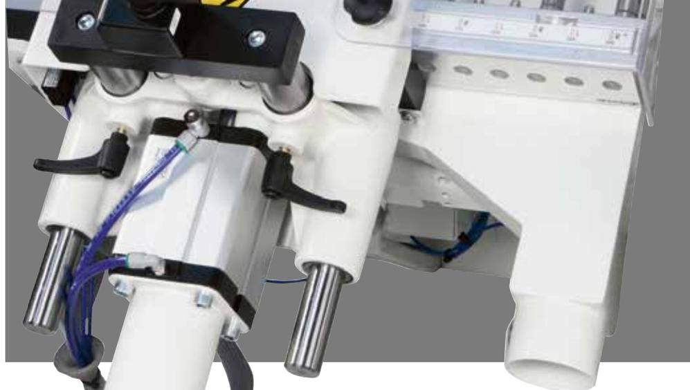
La machine est dotée d'un revolver mécanique avec 5 profondeurs de perçage.
