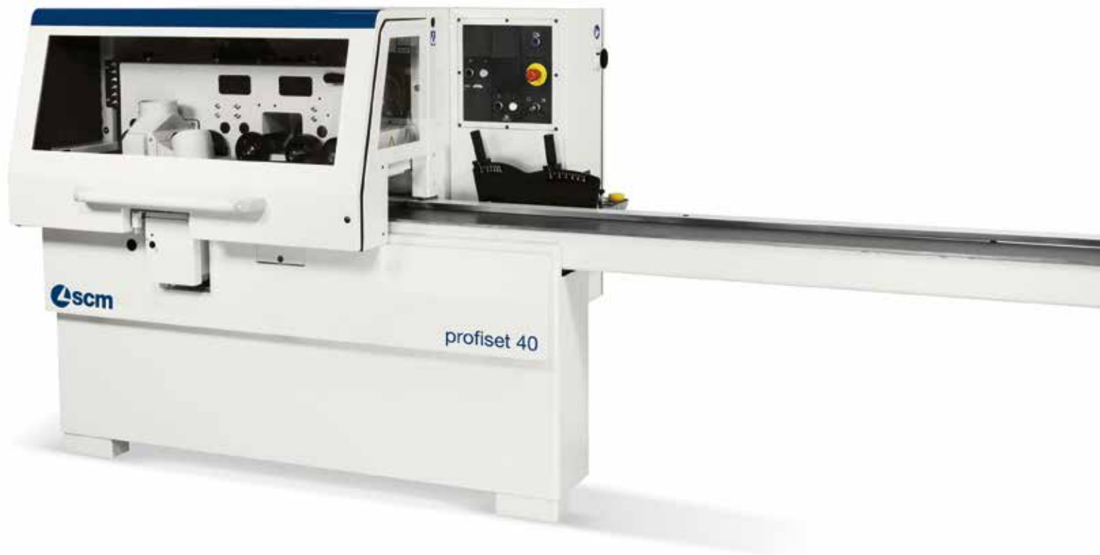
Composition machine à 4 arbres avec capacité de profilage de 10 mm sur les arbres verticaux.
