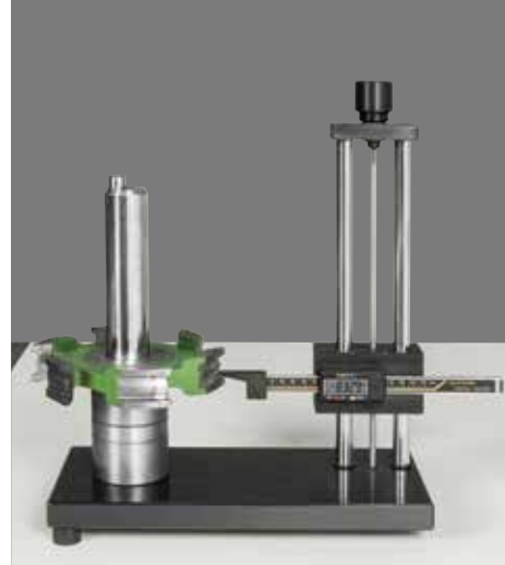
Calibre pour le mesurage du diamètre outils « Preset 25 » Précision centésimale et confort.
