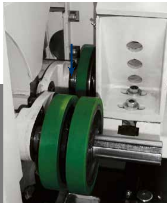
Groupe d'avancement après l'arbre horizontal supérieur
