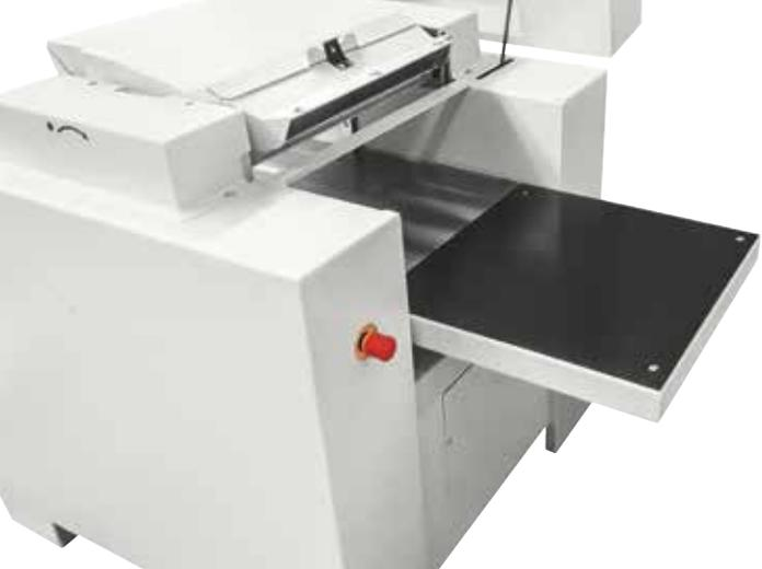
**Rallonge pour la table de rabotage qui peut être utilisée en entrée ou en sortie**
