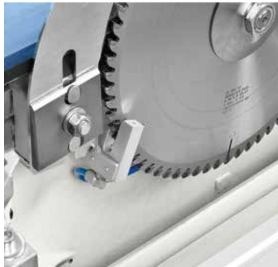
**Dispositif de micro-lubrification de la lame**
