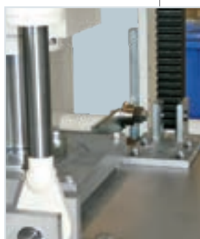
Les cylindres additionnels pour le contrôle de l'ouverture des plateaux permettent un cycle rapide et constant.
