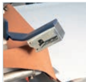
Le kit d'accrochage/décrochage de la membrane permet un passage rapide d'un cycle d'usinage au suivant.
