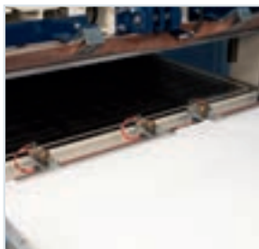
Le plateau mobile inférieur est fraisé afin de créer les circuits qui permettent la génération du vide.
