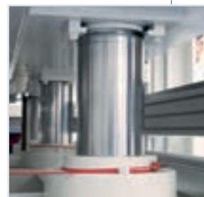
Cylindres hydrauliques La tige en acier est chromée avec une forte épaisseur et rectifiée, les joints sont très résistants afin de garantir une tenue parfaite et durée dans le temps.
