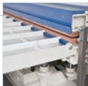
Presseur arrière indépendant pour presser les panneaux en continu.
