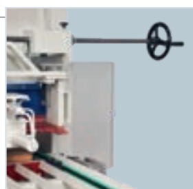
Possibilité de régler la poussée des lames frontales en hauteur (option).
