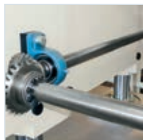
Plateau mobile supérieur guidé par des couples de pignons et crémaillères. Possibilité d'ajouter le contrôle électronique du parallélisme du plateau (opt.).
